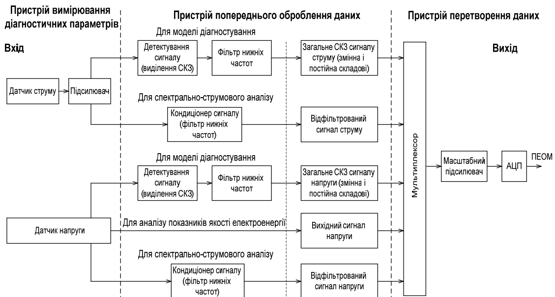
Рис. 2. Структурна схема пристроїв вимірювання, попереднього оброблення і перетворення діагностичних параметрів для однієї фази двигуна
