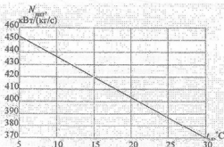
Рис.3. Залежність зниження питомої потужності ГТУ від температури зовнішнього повітря
