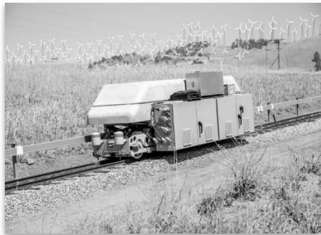
Рисунок 4 – Технологія ARES (Advanced Rail Energy Storage)
