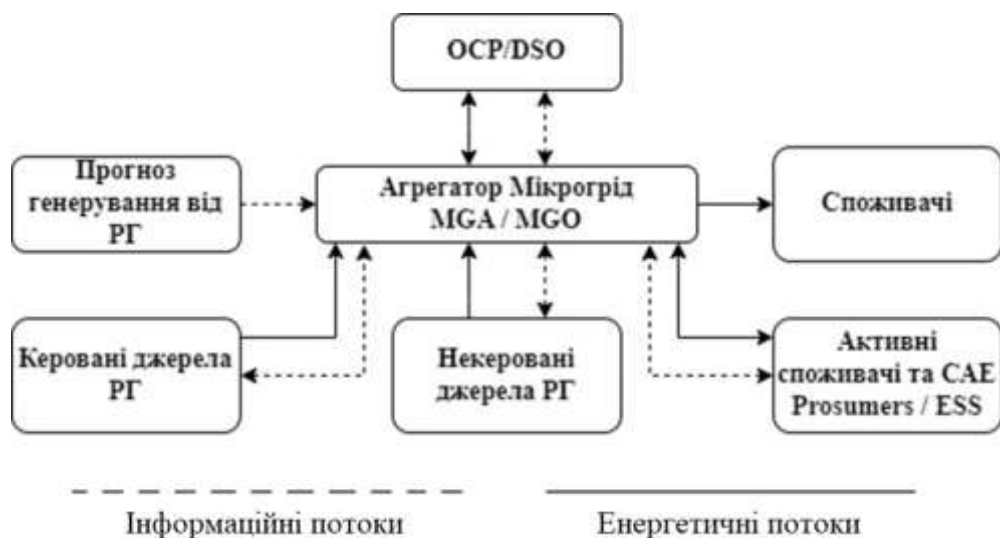
Рисунок 3 – Структура системи Smart-моніторингу Microgrid системи
