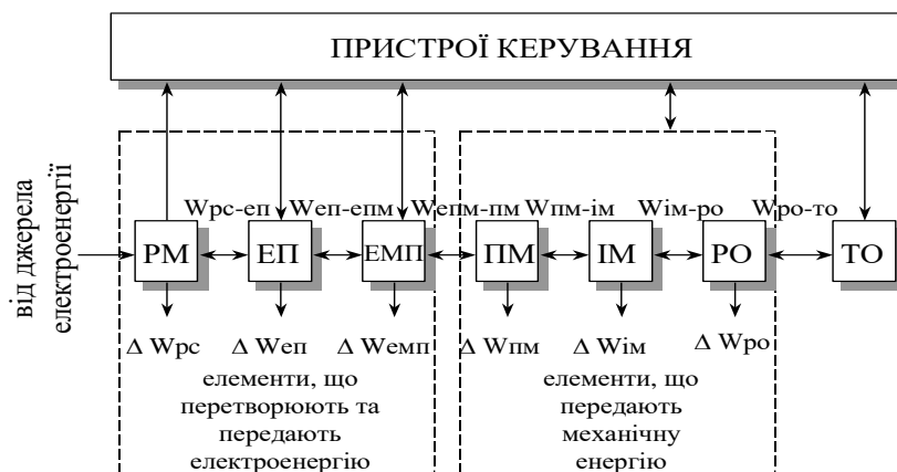
Рисунок 1 – Структура енергетичного каналу електропривода (PM – розподільна мережа, EP – електричний перетворювач, EMP – електромеханічний перетворювач, ПМ – передавальний механізм, ВМ – виконавчий механізм, РО – робочий орган, ТО –технологічний об'єкт (вантаж))
