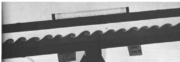
Рис. 1. Нестійкість Кельвіна-Гельмгольца накладених потоків (фото з освітленням лазером)
