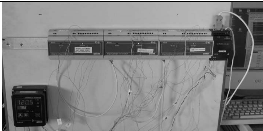
Рис.3. Система измерения температур и плотности солнечного теплового потока
