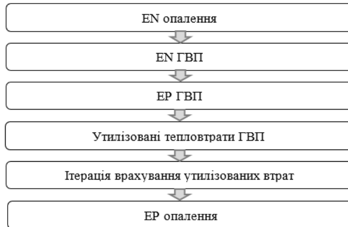
Рисунок 3 – Послідовність виконання розрахунків утилізованих втрат з розподільчих трубопроводів ГВП для уточнення енергопотреби будівлі
