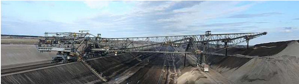
Рисунок 1 - Переміщення на кар'єрах порід у відвали з застосуванням транспортно-відвального мосту
