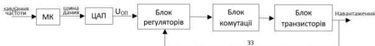
Рисунок 4 - Функціональна схема трифазного генератора ШІМ
