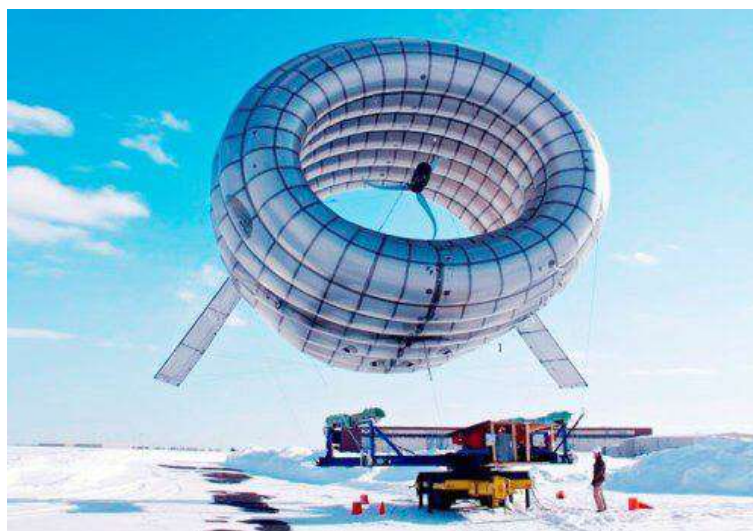
Рисунок 1 - Вітрогенератор Buoyant Airborne Turbine[4]
