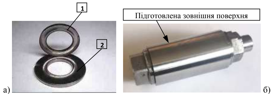
Рисунок 2 – а) пара тертя; б) 25 контрзразків зібрані в касету; 1 – контрзразок; 2 – плоский нерухомий зразок.
