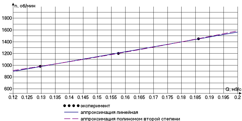
Рисунок 4 - Зависимость частоты вращения n от расхода Q , при которой будет обеспечен максимальный КПД насосной установки. Насос Д630-90.
