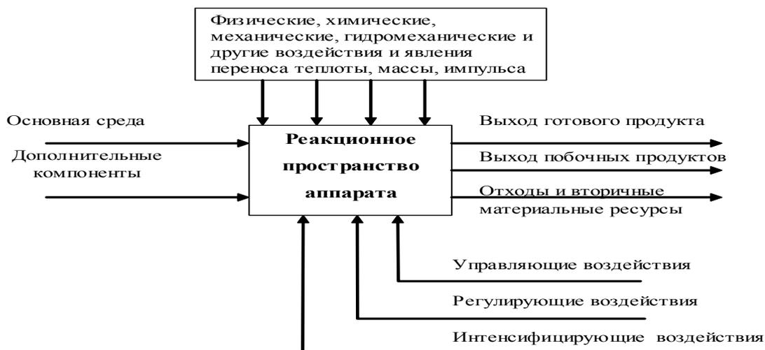
Рисунок 1 – Общая схема технологического процесса
