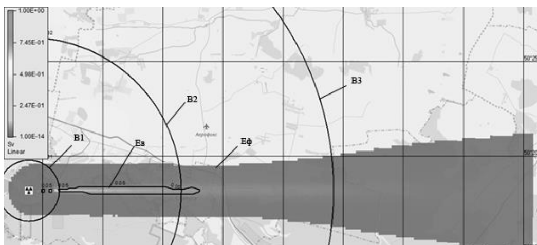
Рисунок 2 – Ефективна доза опромінення на все тіло для обраного сценарію ЗПА в залежності від відстані від майданчика АЕС (ARGOS)
