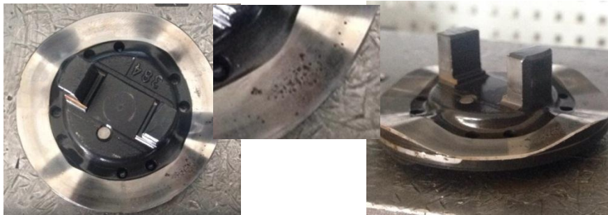
Рисунок 4 – Характерні пошкодження плунжерної шайби паливного насоса високого тиску
