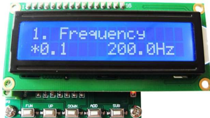
Рисунок 2 – HS380 - мікроконтролерний блок трифазного генератора синусоїдальної напруги
