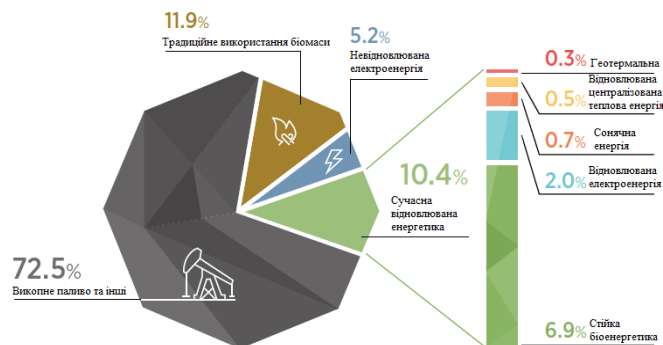
Рисунок 1 – Частка джерел енергії в загальному кінцевому споживанні енергії на системи ОВіК [7]
