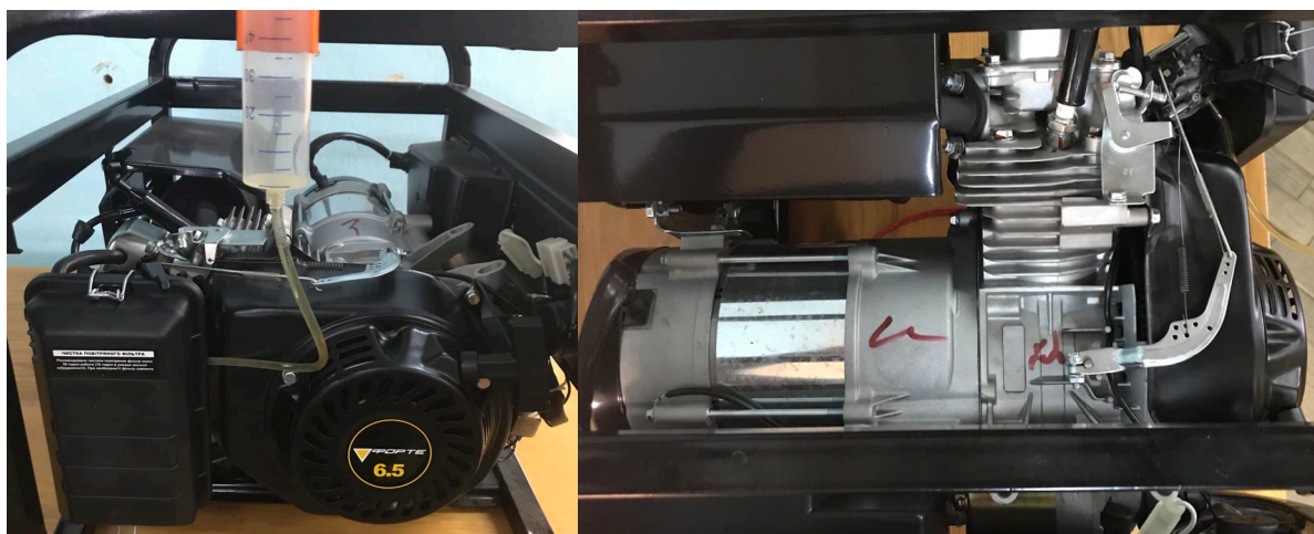
Рис.1 – Зовнішній вигляд генератора електричної енергії з двигуном внутрішнього згорання
