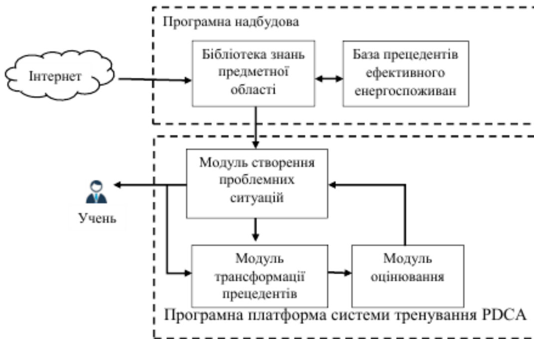
Рис 2. Структурна схема програмного забезпечення комп'ютерного тренажеру енергоменеджера.
