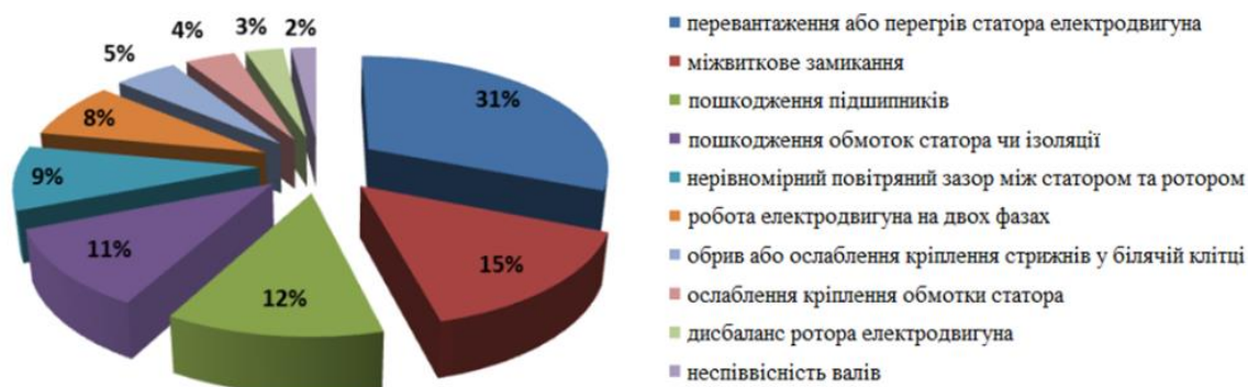
Рисунок 1 - Джерела розвитку пошкоджень в електричних машинах
