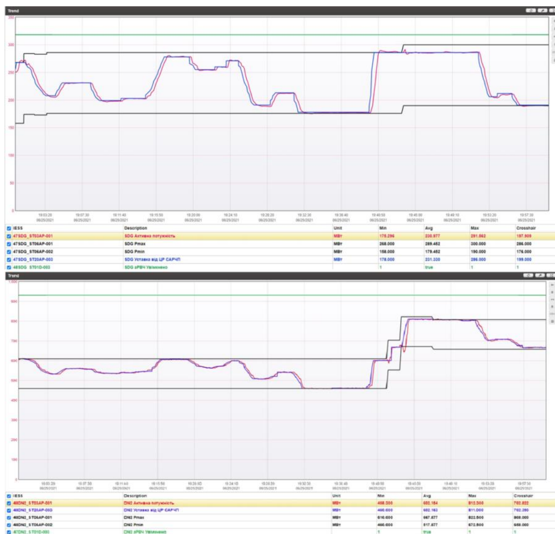
Рисунок 4 – Робота агрегатів ГЕС під управлінням центрального регулятора САРЧП ОЕС України при аварійному відключенні енергоблоку АЕС.
