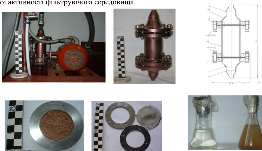
Рисунок 8 - Конструктивні варіанти блоку адсорбційного фільтрування магнітно-ультразвукової системи очищення водних середовищ
