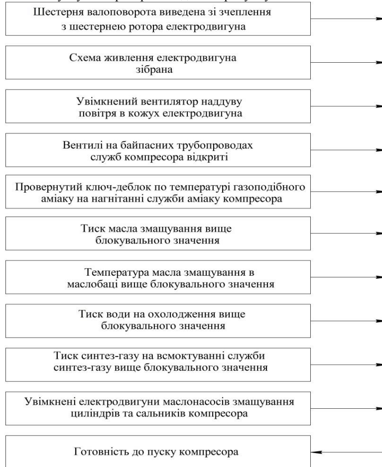
Рисунок 2. Умови готовності до пуску компресора
