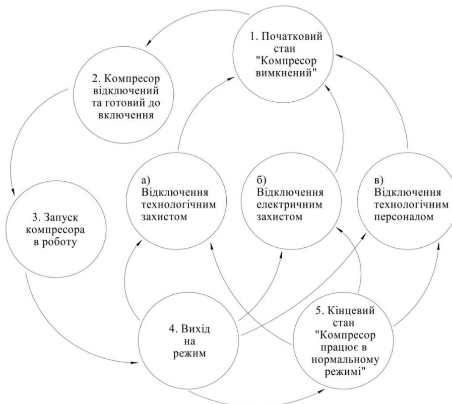
Рисунок 4. Діаграма переходів станів компресорної установки
