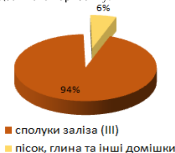
Рисунок 3 – Склад осадів на поліпропіленових фільтрах
