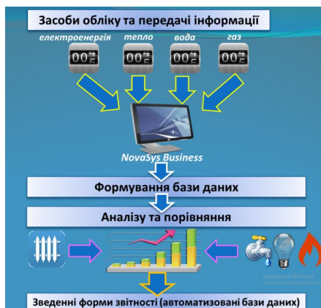
Рисунок 2 – Структурна схема диспетчеризації системи обліку енергоресурсів
