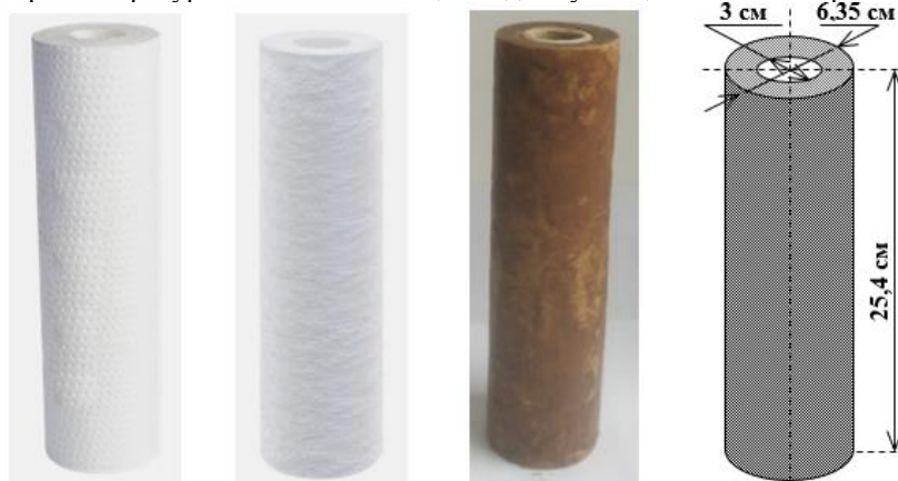
Рисунок 2 – Зовнішній вигляд та розміри типового 10 " поліпропіленового картриджа: а – пресований; б – з поліпропіленової нитки; в – після 6 місяців експлуатації; г – основні розміри
