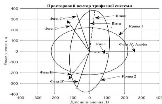
Рисунок 1 - Просторовий вектор трифазної системи з наявністю однофазної несправності де Бета ( \beta ) – уявна вісь Im , Альфа ( \alpha ) – дійсна вісь Re , кут просторового вектору \theta - кут нахилу еліпса
