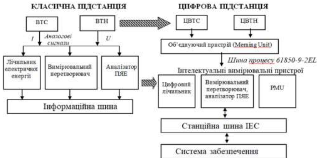
Рисунок 2 - Принцип роботи класичної та цифрової підстанції
