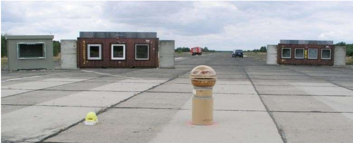
Рисунок 4 - Фото розташування тестових світлопрозорих конструкцій та вибухового заряду на арені для вибухів
