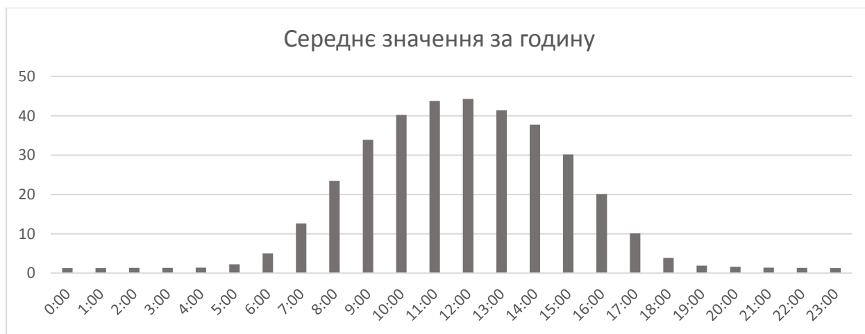
Рисунок 3 – Графік залежності усередненого значення генерації електричної енергії на СЕС по відповідним годинам доби.
