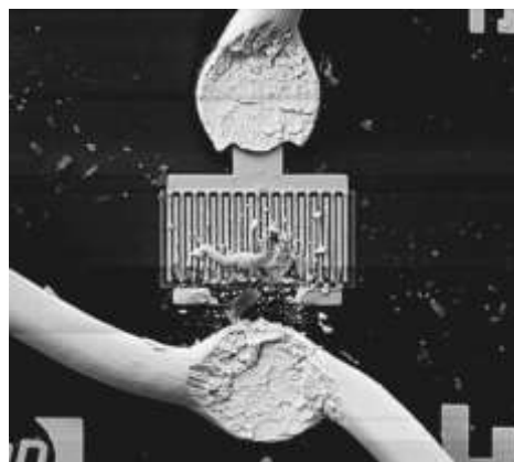
Рисунок 4а - Пошкодження транзистора [19]
