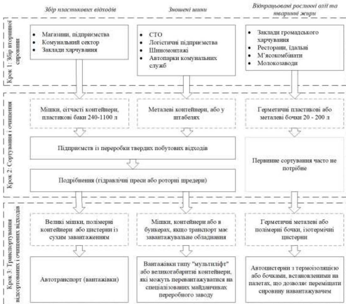
Рисунок 3 – Структурна схема етапу збору та транспортування сировини
