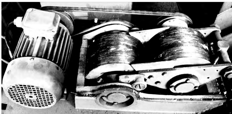
Рисунок 2 – Експериментальна установка сухого збагачення за тертям
