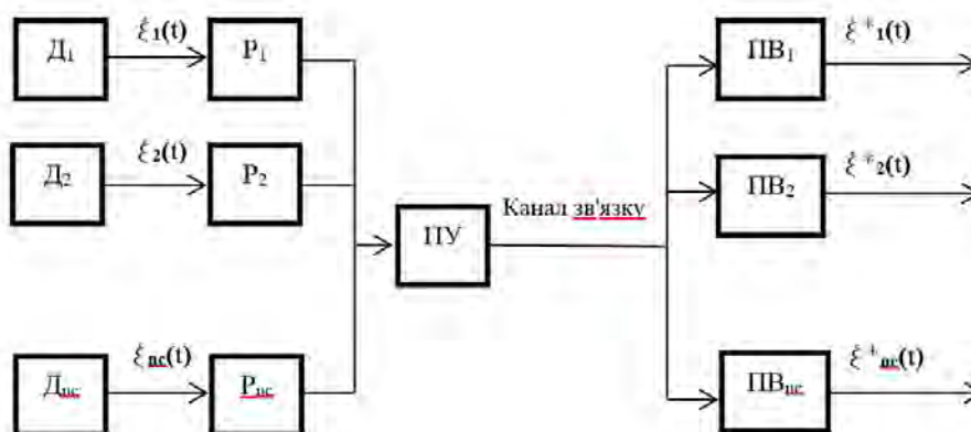
Рисунок 2 – Структура багатоканальної адаптивної системи
