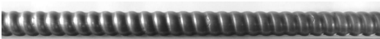
Рисунок 1 – Фотография длинномерной винтообразной трубы диаметром 16 мм и шагом между выступами 8мм.
